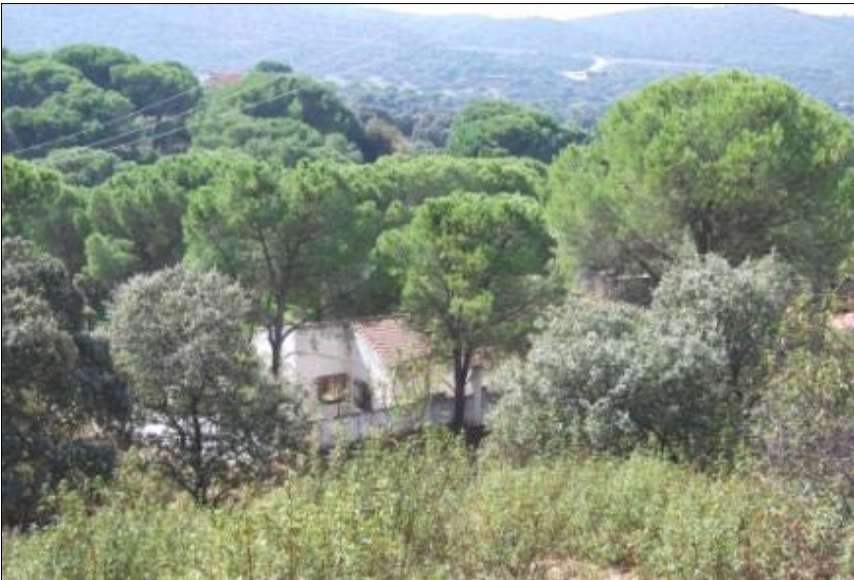
Figura 10. La vegetación circundante a las edificaciones y, en muchos casos, en contacto con las mismas en caso de paso del fuego sirve como vector de propagación e ignición en la estructura. Fuente: Clara Quesada, 2009.
